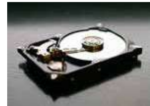
Disco rígido usado para gravação de dados nos computadores.
